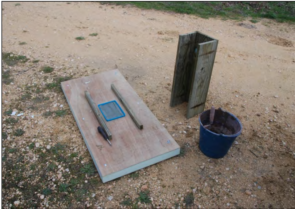
Figura 4. Plataforma flotante antes de su montaje final (falta colocar el túnel y cubrir el huellero con la mezcla de arcilla y arena). Foto: Madis Põdra.
